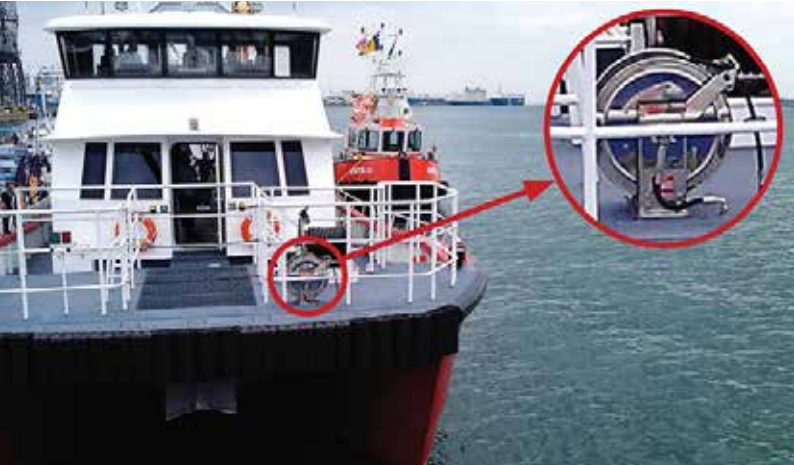
Ayrıca gemilerde oluşan statik elektriğin boşaltılması için topraklama tamburlarımız da mevcuttur.
